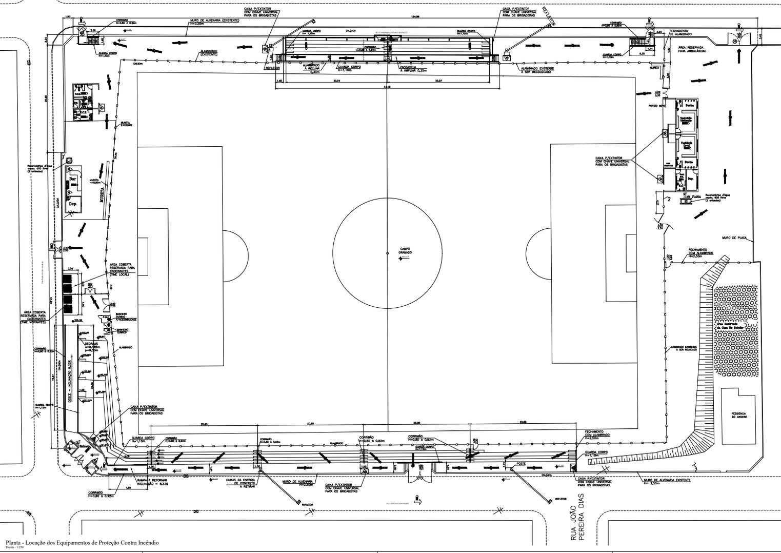
Planta - Locação dos Equipamentos de Proteção Contra Incêndio
